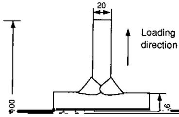
溶接ワイヤは、本技術の場合も溶接割れ防止の観点より、低C系であるKW-50の適用が基本となる。
