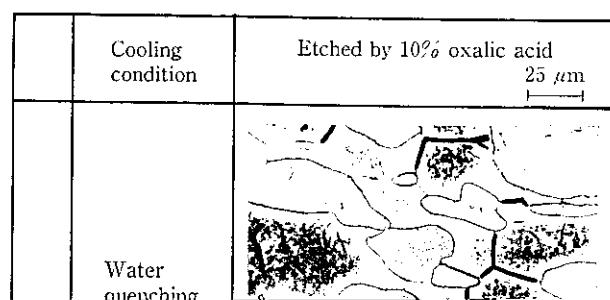
拡散しうるため、クロム窒化物そのものの数が少ないと考えられる。この推論の証拠として、Photo 5 に示すように水冷材でもオーステナイト相近傍のフェライトは銳敏化していない。
